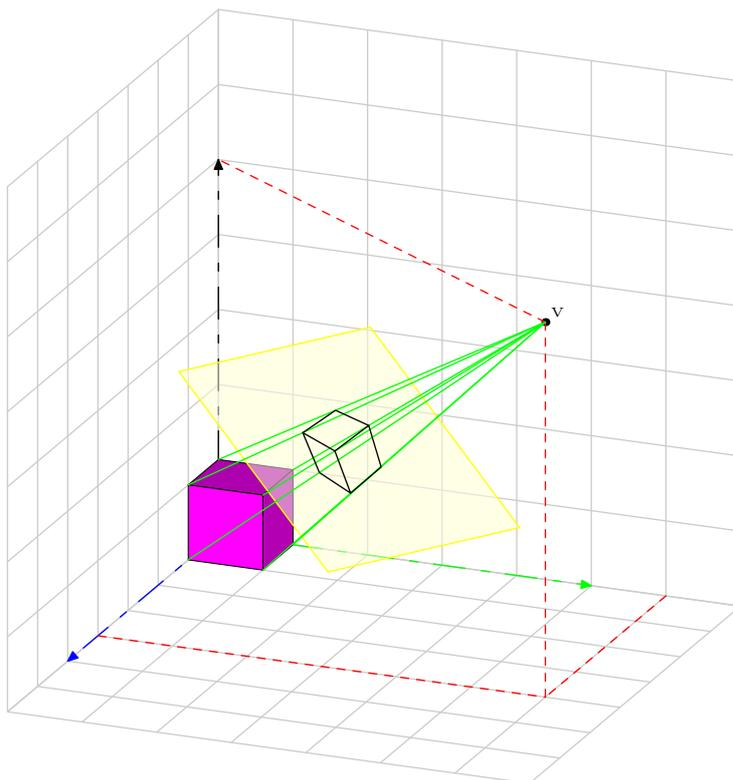
Les coordonnées de l'objet, ici le cube violet, sont données sous forme d'un triplet<sup>33</sup> dans le repère  $Oxyz$ . Les coordonnées du point de vue  $V$ , sont données dans ce même repère en coordonnées sphériques sous la forme  $(22, 20, 30)$ .
